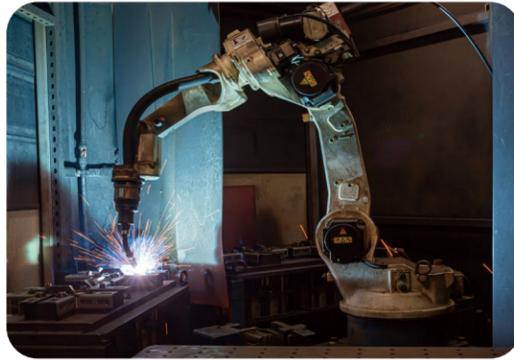
复合型机器人集合了智能移动机器人、通用工业机器人等工作单元，采用视觉误差补偿等技术，满足了企业智能化数字车间对整个机械结构运动精度的苛刻要求，解决了因多个运动单元的误差累积而造成精度不达标的问题，极大地拓展了工业机器人的应用适应性。
