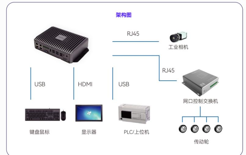
1. **产品超高性能**：作为数据采集、交互终端，产品支持Intel®11代处理器和Windows/Linux/Ubuntu操作系统，为焊接机器人系统输出焊接参数、运动轨迹等指令，以及保障工业相机在复杂工况条件下实现数据实时监控与传输，提供强劲算力支撑；
